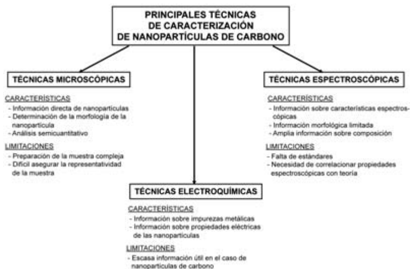
FIGURA V.2. Ventajas y limitaciones de las técnicas microscópicas, espectroscópicas y electroquímicas para la caracterización de nanopartículas de carbono.
