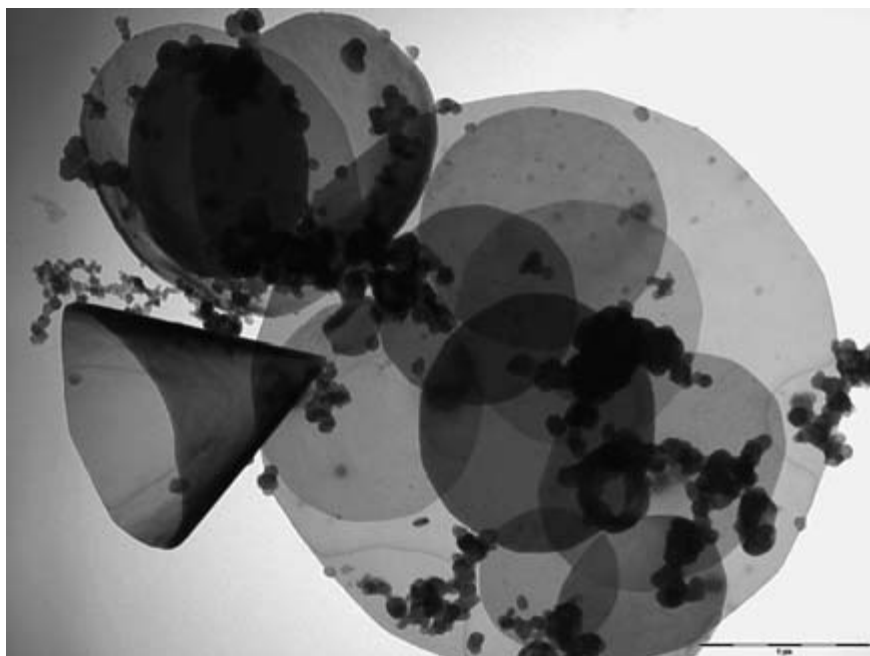
FIGURA III.10. Fotografía mediante microscopía electrónica de transmisión (TEM) de una mezcla comercial de nanoconos, discos de carbono y carbón amorfo. De la referencia [42]
