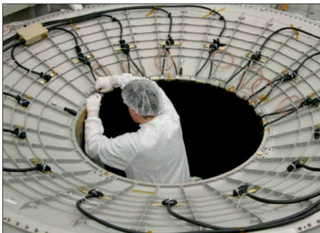
Figura 28. Instalación de los Contadores de Anti-Coincidencia (ACC)
