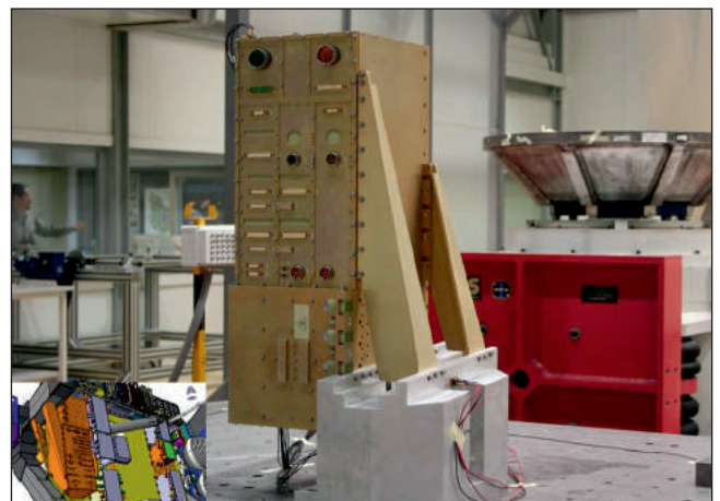
Figura 38. La caja aviónica CAB del imán superconductor
