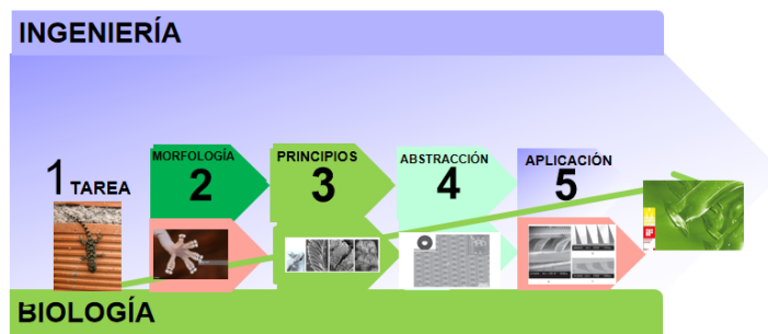
Figura 3. Trabajo bioinspirado en el gecko “de abajo hacia arriba bottom-up”. Identificación del modelo biológico (1). Análisis de la morfología funcional (2). Identificación los principios de funcionamiento (3). Abstracción del modelo biológico y formulación de modelos tecnológicos (4). Aplicación de la tecnología y pruebas en prototipos (5.)
