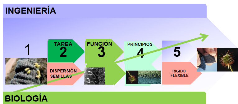
Figura 1. Metodología de trabajo bioinspirado "de abajo hacia arriba (bottom-up)". Elección del sistema biológico (1). Tarea realizada (2). Análisis de la estructura y de la función (3). Identificación de los principios de funcionamiento (4). Modelo tecnológico y prototipos (5)
