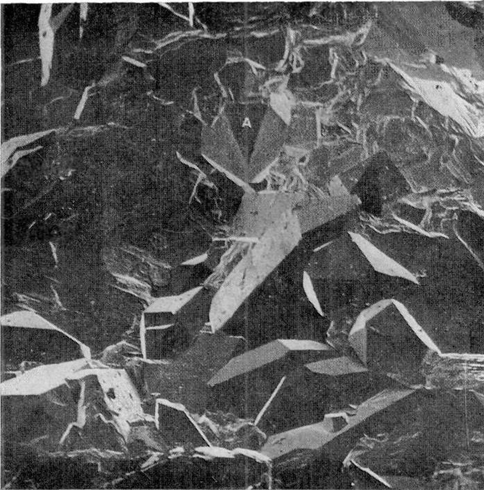
Fig. 10b ( $\times 135$ ) Mena de Almadén: La misma zona de la micrografía anterior después de atacar cinco minutos en agua regia; obsérvese cómo en el punto A marcado en la anterior, se ha difuminado su perfil, mientras se conserva intacto el de los cristales de  $\text{SiO}_2$ .
