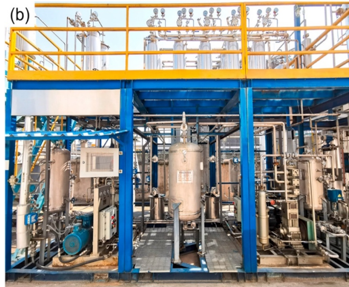
Figura 11. Planta piloto de membranas en 2 etapas para la captura de CO 2 de gases residuales sintéticos 73
