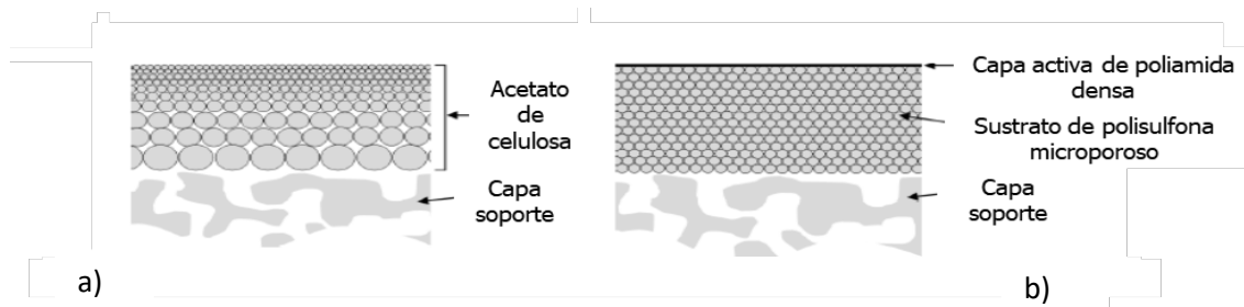
Figura 24. Primeras membranas de ósmosis inversa. a) Membrana de OI de acetato de celulosa, b) membrana densa compuesta con capa activa de poliamida 98
