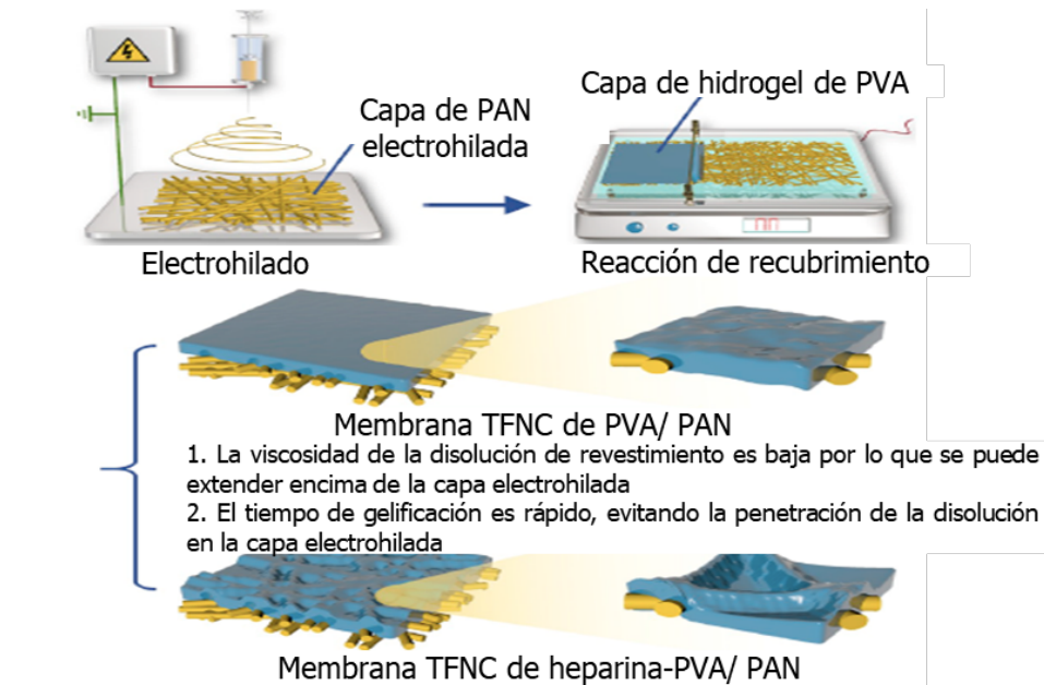
Figura 43. Proceso de fabricación de las membranas de hemodiálisis con recubrimiento de un hidrogel heparina –PVA sobre PAN
