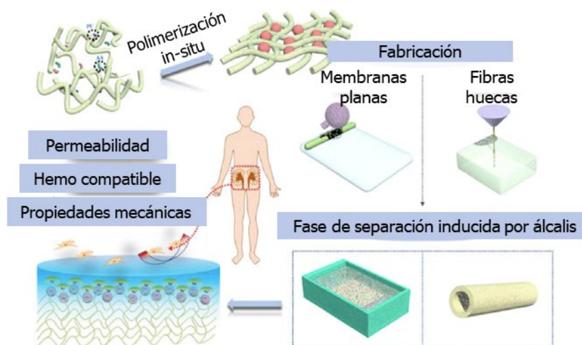
Figura 44. Proceso de separación de fase inducido por NaOH en la síntesis de membranas mimetizando la heparina
