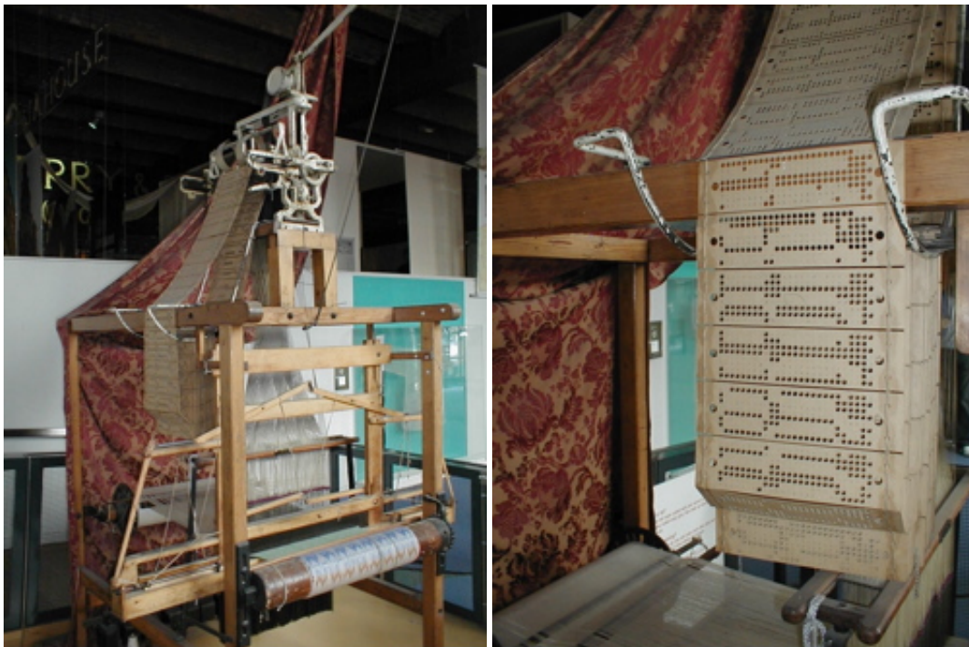
Figura 10.7: A la izquierda, una máquina de tejer o telar de Jacquard. A la derecha, detalle del telar de Jacquard donde se muestra el patrón de agujeros que da origen a las tarjetas perforadas de las antiguas computadoras clásicas.
