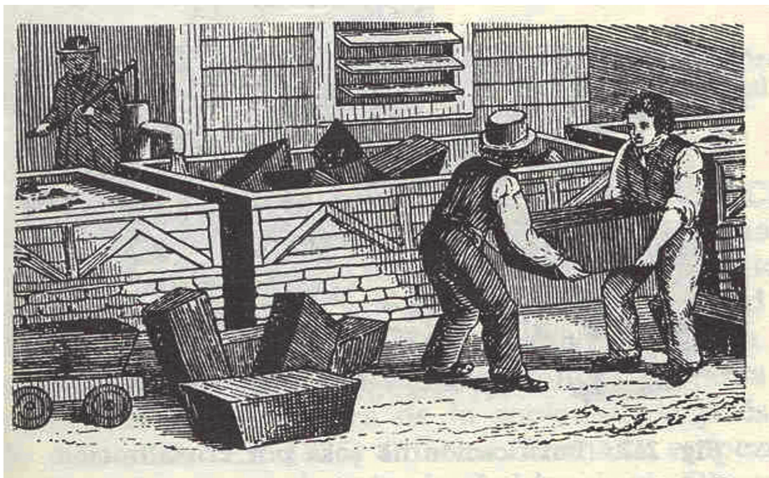
Figura 2. Extracción de la sosa contenida en las cenizas negras. Residuo: “galligu”. (Derry & Williams, 1990).
