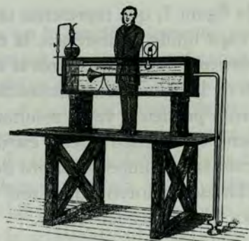
FIGURA 1. Experimento de Reynolds (1883) para estudiar la transición a la turbulencia en tubos.
