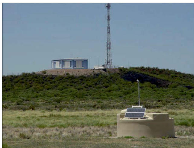
Figura 30. Detector de superficie y telescopio de fluorescencia del Observatorio Pierre Auger Sur (Malargüe, Argentina)
