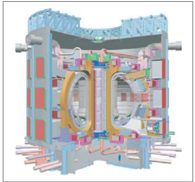
Figura 8. Sección del ITER (International Thermonuclear Experimental Reactor).
