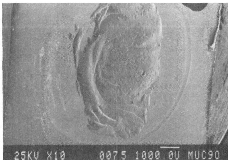
Fig. 6. Fractografía de una unión AA 7075-Alúmina ensayada a cortadura.
