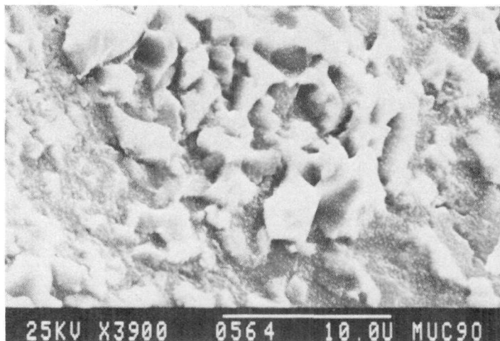
Fig. 8. Detalle de cristales de \text{Al}_2\text{O}_3 adheridos a la aleación.
